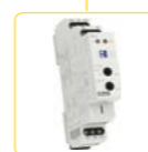
SOU-1 Alkonykapcsoló Tápfeszültség: AC 230 V és AC/DC 12-240 V Kimeneti kontaktus: 1x váltóérintkező 16 A.
